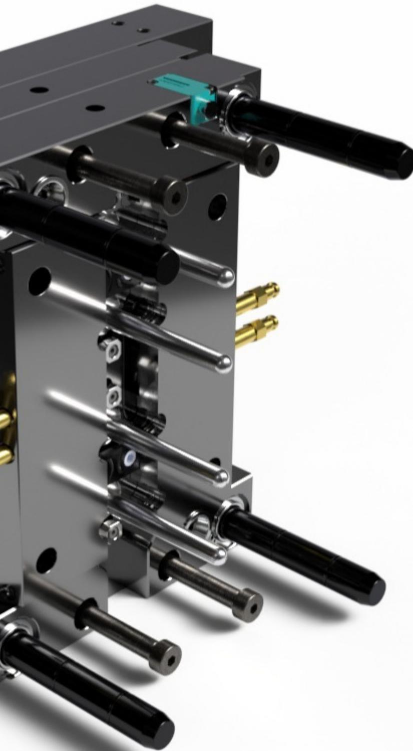
Unsere Multikavitätenwerkzeuge zeichnen sich durch kurze Zykluszeiten und eine kompakte Bauweise aus. Diese Effizienz erreichen wir unter anderem durch eine konturnahe Kühlung mit gleichzeitig geringem Druckverlust. Entscheidend ist dabei nicht nur die Kühlleistung selbst, sondern vor allem die gleichmäßige Temperierung aller Kavitäten.
